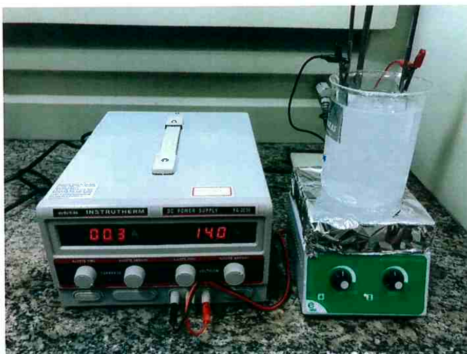
Figura 3. Montagem experimental utilizada para o processo de anodização da liga 2024 – T3 com e sem clad.
