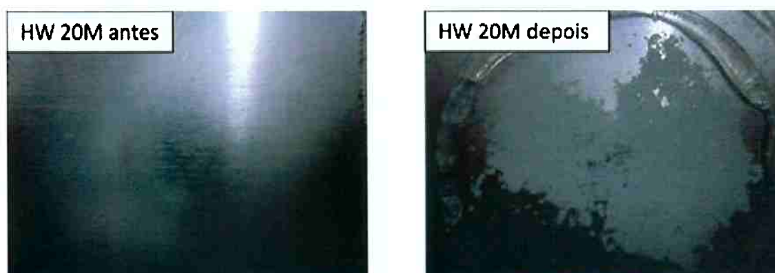
Figura 31. Aparência superficial da amostra da liga 2024-T3 clad anodizada em TSA com pós-tratamento HW 20M como preparada (antes) e depois de ensaio por 672h em solução de NaCl 0,1M.
