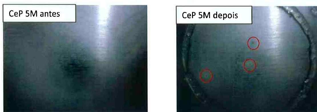
Figura 34. Aparência superficial da amostra da liga 2024-T3 clad anodizada em TSA com pós-tratamento CeP 5M como preparada (antes) e depois de ensaio por 672h em solução de NaCl 0,1M.
