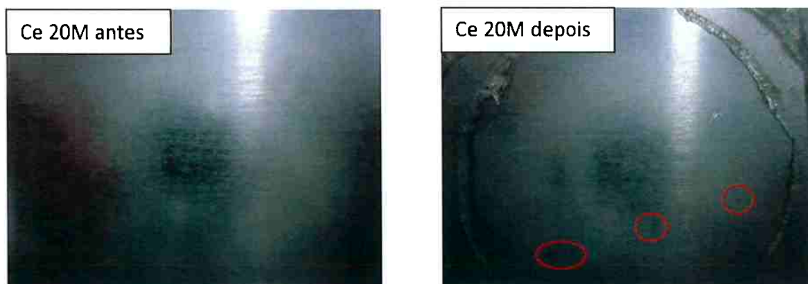
Figura 32. Aparência superficial da amostra da liga 2024-T3 clad anodizada em TSA com pós-tratamento Ce 20M como preparada (antes) e depois de ensaio por 672h em solução de NaCl 0,1M.
